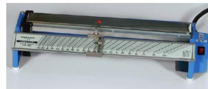
**Doc** Le banc Köfeler permet de mesurer la température de fusion des solides.
