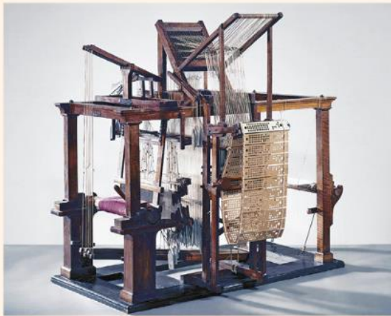
▲ 1801 : Jacquard automatise le métier à tisser à l'aide de cartes perforées.
