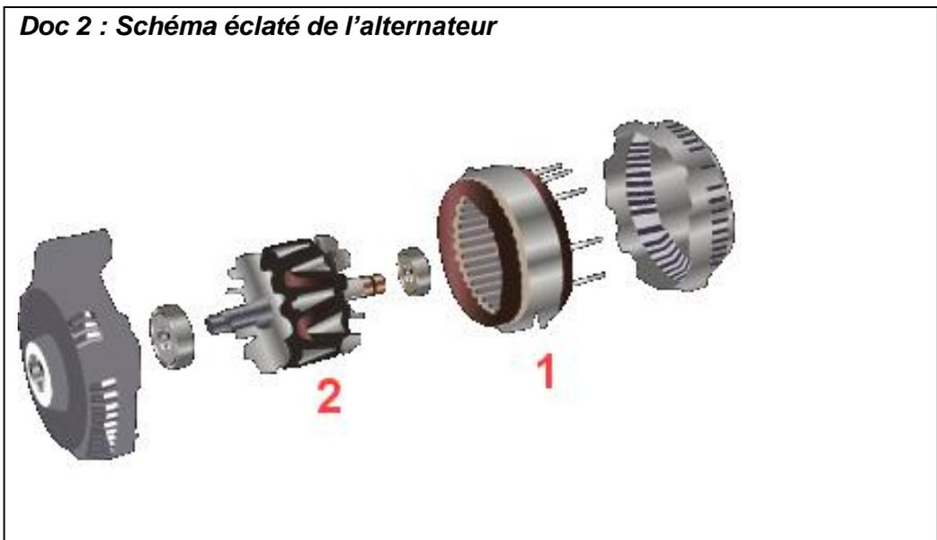
1. A l'aide de ce schéma éclaté de l'alternateur, donner le nom de la partie 1 composée d'une bobine fixe. Donner le nom de la partie 2 et dire de quoi elle est constituée.
